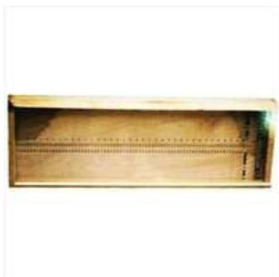
**Коробка мерная** предназначена для определения необходимого и среднего расхода щебня при устройстве ШПО.
