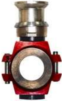
Приспособление для испытания образцов асфальтобетона по методу Маршалла
