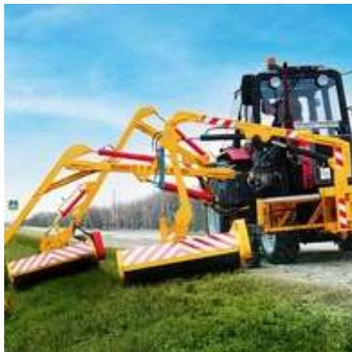
Навесные манипуляторы «Стриж» предназначены для скашивания и измельчения травы, мелкого кустарника, формирования крон деревьев. Идеально подходят для содержания автомобильных дорог в труднодоступных местах, в том числе и за барьерными ограждениями. Устанавливаются на трактор массой не менее 3000 кг («МТЗ-80-100» и т.п.).
