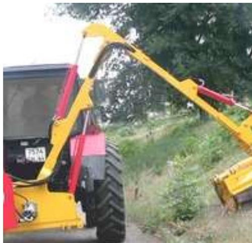
Навесной манипулятор «Стриж» предназначен для скашивания травы и ликвидации нежелательной древесно-кустарниковой растительности на обочинах и откосах дорог, а также уборку снега в труднодоступных местах. Устанавливается на трактор массой не менее 3000 кг («МТЗ-80-100» и т.п.). Крепится на три точки задней навески трактора. Длина стрелы с рабочим органом до 7 метров.
