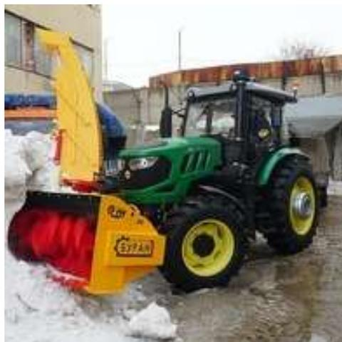
Снегоуборщик «Буран-3» предназначен для очистки дорог от слежавшегося и свежеснежавшегося снега, удаления снежных валов с дорог, образовавшихся при работе бульдозеров и плужных снегоочистителей, а также пробивки дорог по снежной целине.
