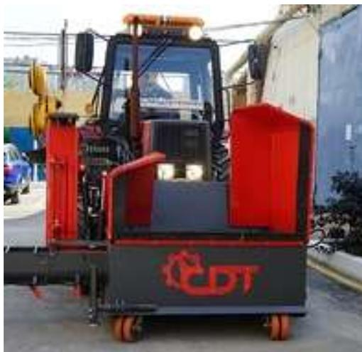
Навесной асфальтоукладчик предназначен для устройства тротуаров, велосипедных дорожек, ямочного ремонта большими картами из горячих и холодных асфальтобетонных смесей. Габариты асфальтоукладчика позволяют использовать его в стесненных условиях или, где невозможно или нецелесообразно использовать тяжелую технику. Возможно распределение инертных материалов (песка, мелкофракционного щебня), уплотняемых цементобетонных смесей (тощего бетона).
