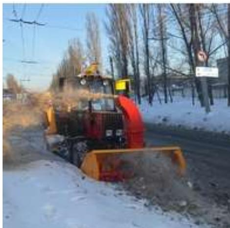
Фрезерно-роторный снегоочиститель «Буран» предназначен для очистки дорог от свежеснежившего и слежавшегося снега, удаления снежных валов с дорог, образовавшихся при работе бульдозеров и плужных снегоочистителей, а также для пробивки дорог по снежной целине. Комплектуется коротким раструбом для очистки дорог и длинным раструбом для погрузки снега в кузов грузовика. В качестве режущего органа снегоочиститель имеет горизонтальную фрезу ленточного типа, а в качестве отбрасывающего органа ротор.
