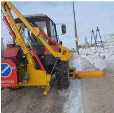
Фреза для дорожных обочин – это современное оборудование, предназначенное для планировки обочин, откосов, очистки барьерных ограждений между стойками. Убирает грунт, снег, наледь и откидывает на расстояние до 2-х м от дороги. Обеспечивает очистку обочин от валов снега.
