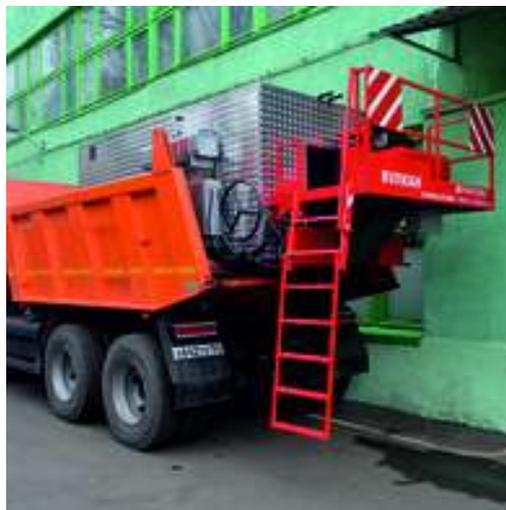
Используется для ямочного ремонта зимой литым асфальтом при температурах до -10°C, летом горячими асфальтобетонными смесями.
