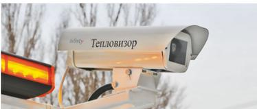
Тепловизор. Обеспечивает автоматическую съемку поверхности покрытия дороги инфракрасной видеокамерой. Позволяет выделить участки автомобильных дорог с повышенным водонасыщением и влажностью.
