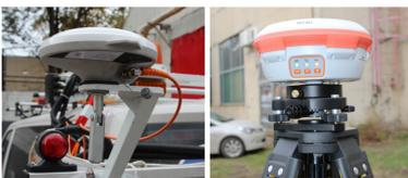
Геодетическая система GPS/Глонасс. Предназначена для получения высокоточных GPS-координат и привязки данных измерений дорожной лаборатории к ним. В комплект входят: базовая станция, ровер, геодезический штатив, полевой контроллер и модуль GPS в составе ПИК «Дорога-ППО».
