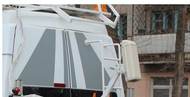
Система полуавтоматической видеодетекции покрытий автомобильной дороги на основе высокоскоростной линейной камеры.
