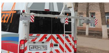
Система измерения параметров поперечной ровности
