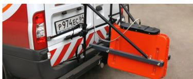
Система подповерхностного зондирования на основе георадара «ОКО-2». Предназначена для обнаружения различных объектов и полостей под полотном дороги. Глубина зондирования от 0,8 до 3,5 м. в зависимости от типа применяемого навесного блока. Конструкция дорожной одежды определяется с разрешающей способностью 2 см.
