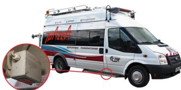
Система измерения ровности покрытия дорог по международному показателю IRI. Представляют собой два моноблока с лазерными датчиками и акселерометрами, которые устанавливаются под днищем кузова лаборатории по полосам наката.
