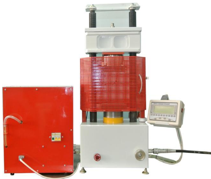
Рисунок 1 - Внешний вид пресса гидравлического измерительного ПГИ-500-02
