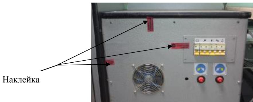
Рисунок 5 – Место пломбировки бортового вычислительного комплекса
