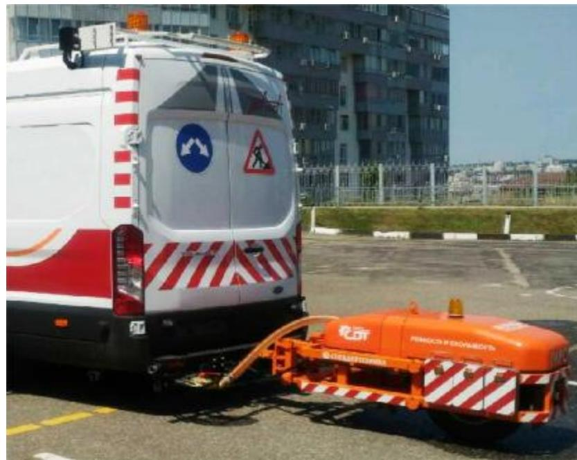
Рисунок 3 - Общий вид комплексов измерительных передвижных дорожных лабораторий ТРАССА 2 с прицепным устройством ПКРС
