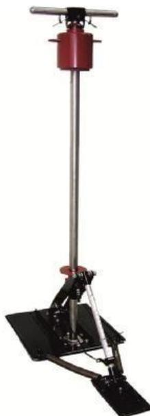
Рисунок 1 – Общий вид измерителя коэффициента сцепления портативного ИКСп-2У
