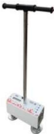
Профилометр ПКР-3М предназначен для определения по ГОСТ Р 56925-2016 продольной ровности, приведенной к показателю IRI, слоев покрытия и оснований дорожной одежды при промежуточной приемке и вводе в эксплуатацию автомобильных дорог.
