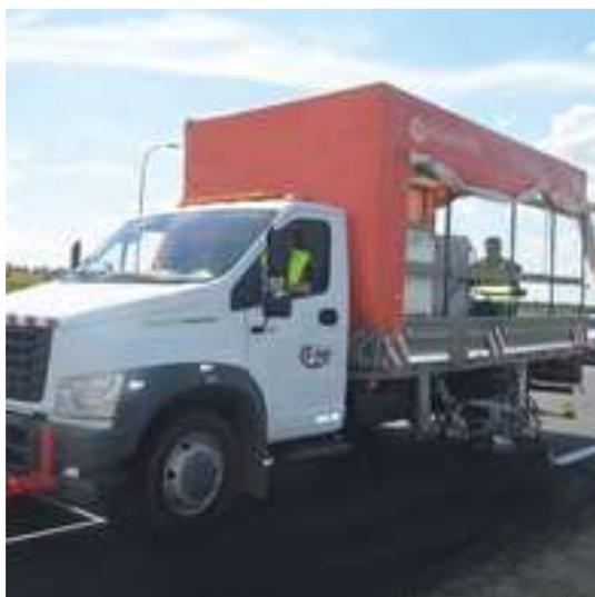
Предназначена для нанесения дорожной разметки термопластом с применением экструдера.
