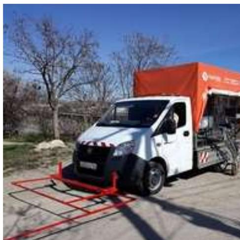
Предназначена для выполнения работ по нанесению горизонтальной разметки на автодорогах как «холодным» двухкомпонентным пластиком (в соотношении 50/50), так и всеми видами дорожных красок.
