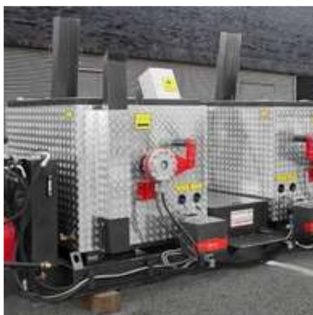
Обеспечивает разогрев термопластика до рабочей температуры и заправки им маркировочных машин.
