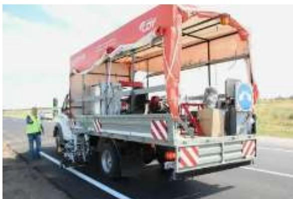
Предназначена для нанесения горизонтальной разметки и символики на автодорогах (стоянки, пешеходные переходы, стрелки, стоп-линий) как «холодным» двухкомпонентным пластиком (в соотношении 50/50), так и обычными дорожными красками.
