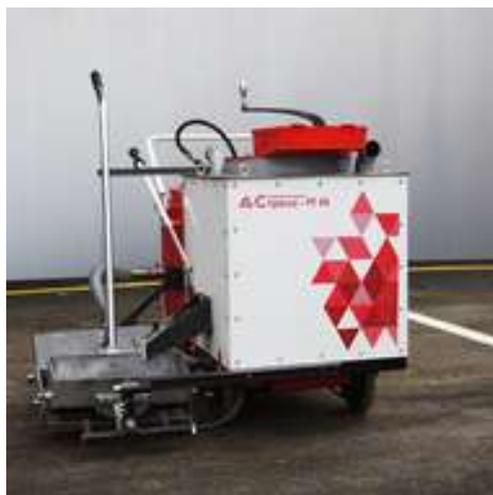
Используется для нанесения горизонтальной разметки термопластиком на пешеходных переходах.
